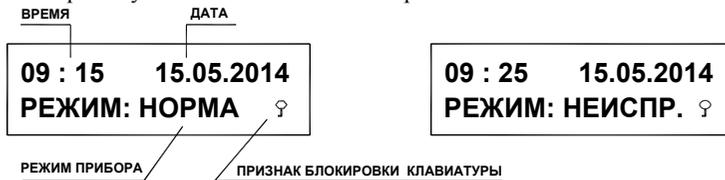
Рис.1.2.1. Примеры индикации при отсутствии не квартированных событий.
