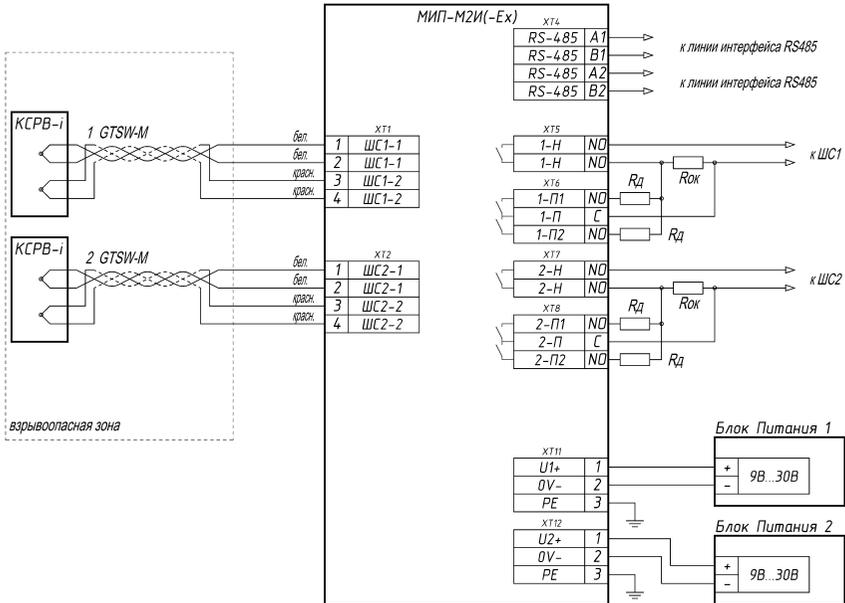
Рис. Г.1. Схема подключения модулей «МИП-М(1...2)И(-Ех)».
