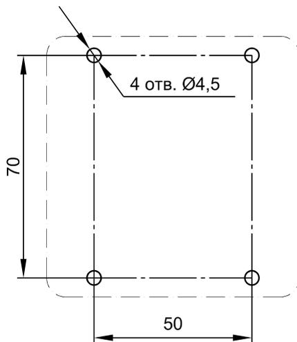
**Рис. Д.1** Разметка для крепления модулей «МИП-М(-Ех)»,
