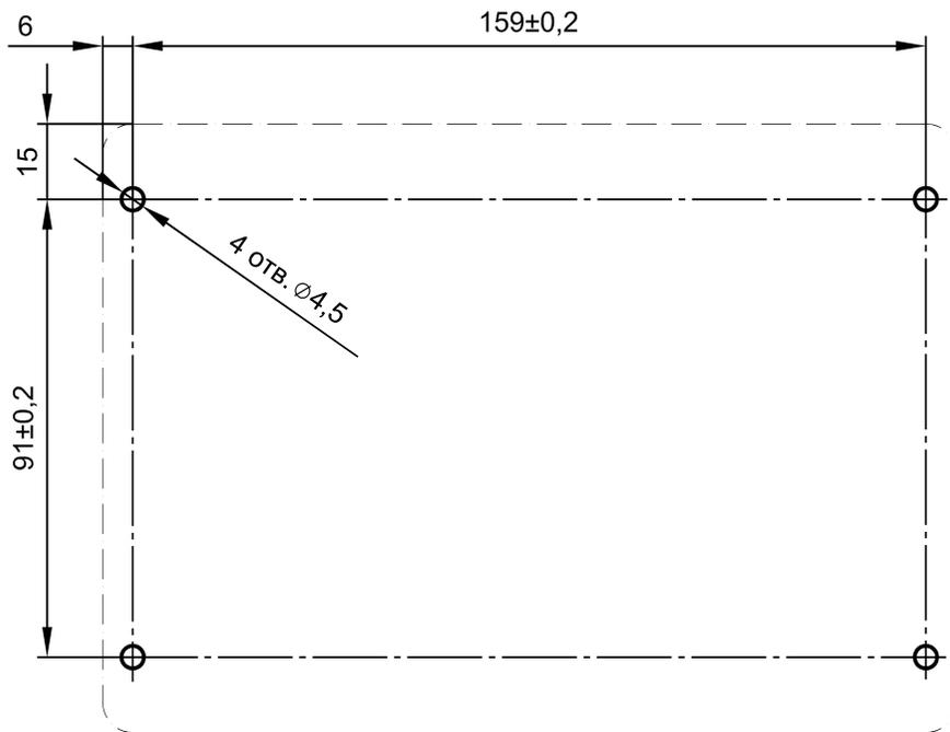
**Рис. Д.2** Разметка для крепления модулей «МИП-М(1...2)И(-Ех)»
