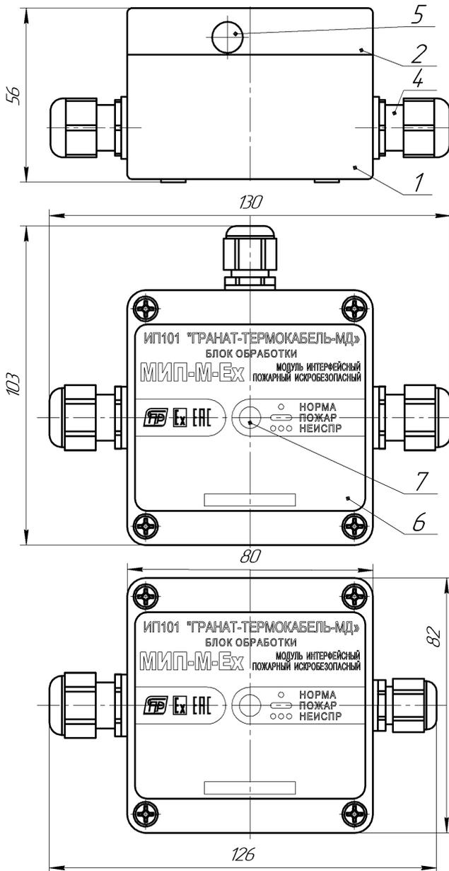
Рис. А.1. Внешний вид модулей МИП-М(-Ex).
