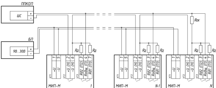
**!!! все перемычки кроме J4 на МИП-М должны быть сняты, перемычку J4 установить горизонтально**
