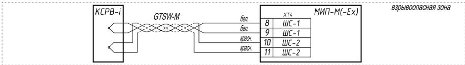
Размещение извещателя с блоком обработки «МИП-М» во **взрывоопасной** зоне недопустимо.
